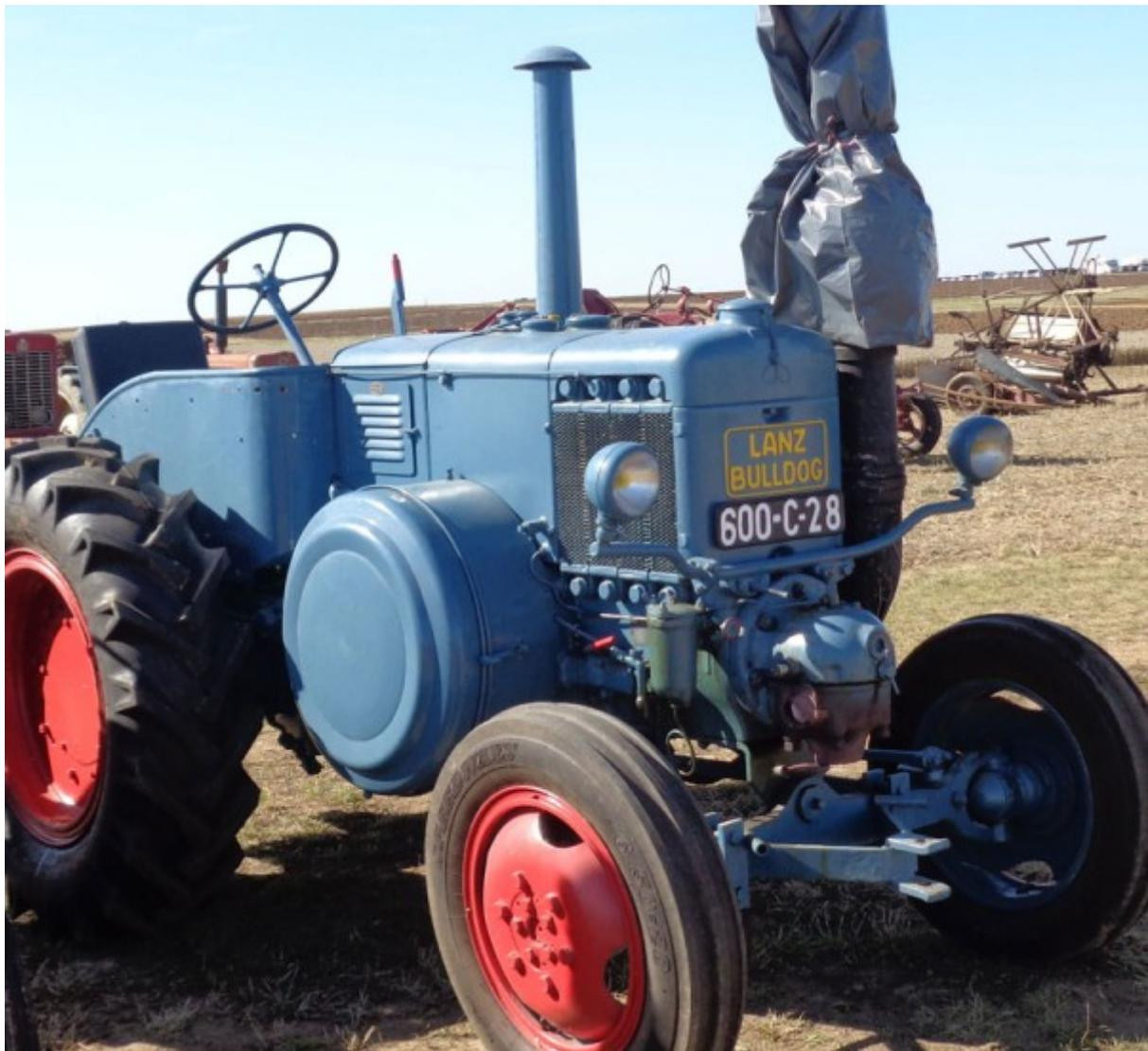
Un tracteur semi diesel monocylindre Lanz de fabrication allemande
