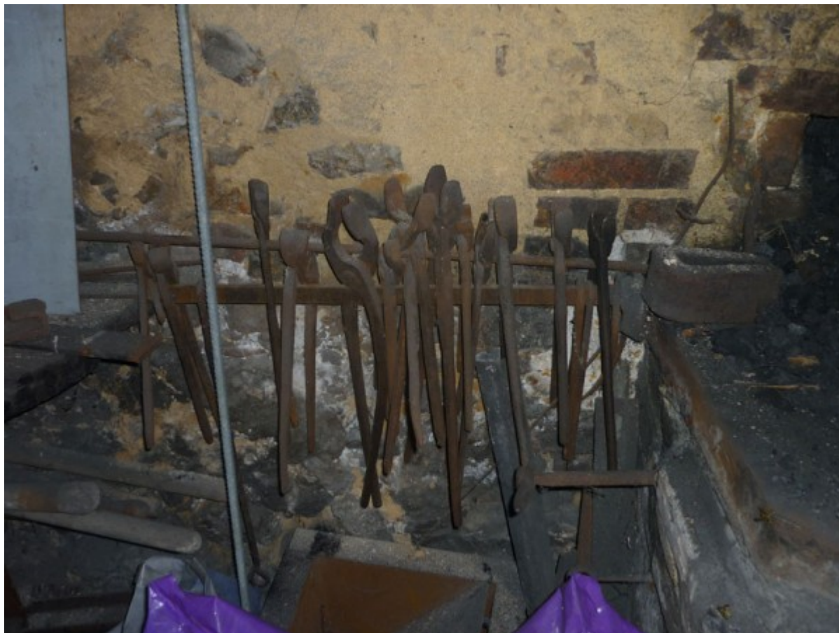
Une partie des tes tenailles ou des pinces ayant chacune un nom qui désigne sa fonction
